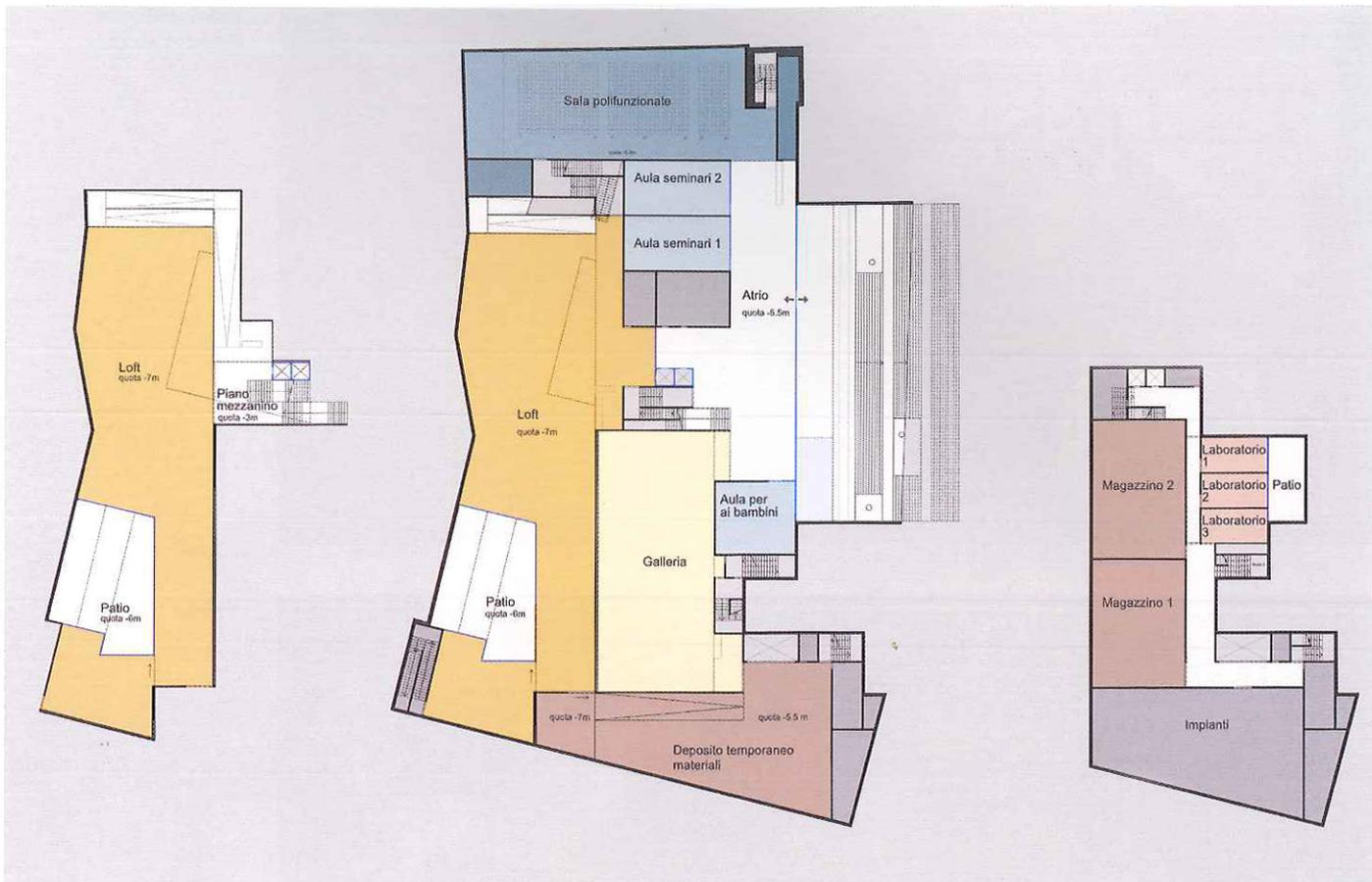
**Da sinistra: piante del piano mezzanino (quota -3 m), del piano interrato -1 (quota -5.5 m e -7 m) e del piano interrato -2 (quota -10 m). In basso: sezione trasversale**
